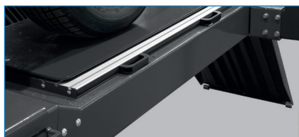
Präzisions-Schiebeplatte (Option, nur für „W“-Ausführung): Minimales Losbrechmoment 5 Nm und minimale Verschiebekraft 15 N bei 500 kg Radlast, große Menge an Stahlkugeln, gehärtete Lauffläche, Auffangrillen für Schmutzwasser (Abb rechts: obere Platte abgenommen)
