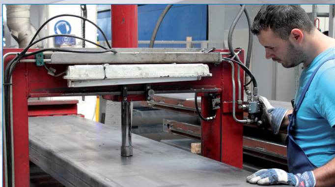
Option „Absetzvorrichtung“: Bei Hebebühnen für die Fahrwerksvermessung wird jede Fahrfläche im Bereich der Drehteller- und Schiebeplattenauflagen nach dem Schweißen auf einer Vorrichtung exakt eben gerichtet.
