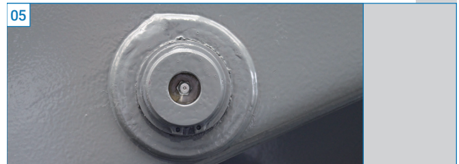
05 Scherhauptlager mit Teflon-Gleitlagerbuchse und Schmiernippel, hohe Lebensdauer und Notlaufei- gschaften.
