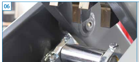
Die Zylinder-Aushubunterstützung mit Stufenhebel und Rollen führt eine reine Abrollbewegung aus. Keine Gleitbe- wegung zwischen den bewegten Teilen, dadurch geräusch- los, verschleiß- und wartungsarm.
