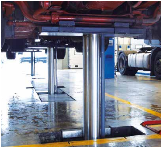
Alle SLiFT TRUCKLIFT-Anlagen verfügen über eine Gleichlaufregelung nach DIN EN 1493.
