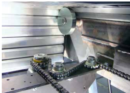
Sichere Kettenführung zur genauen Positionierung der Hubeinheiten
