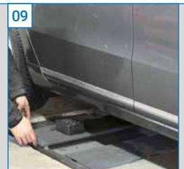
Hoher Korrosionsschutz am Bodenrahmen durch serienmäßige Zweischicht-Pulverlackierung.
