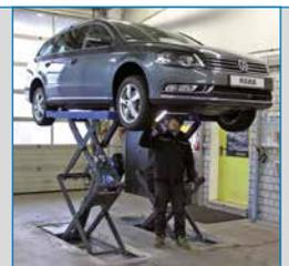
Sehr große Auszugslänge der Aufnahmeplatten (1550 – 2100 mm), dadurch ist das Anheben auch von kleineren Transportern möglich.
