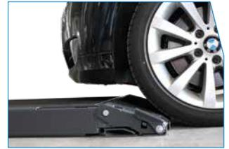
Bei einer Überfahrhöhe von lediglich 105 mm dienen die klappbaren Auszüge zudem als Auffahrrampe.
