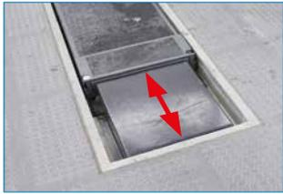
Durch Fundament-Ausgleichskästen (im Lieferumfang) sind die beiden Auszüge auch im abgelassenen Zustand der Hebebühne längenverstellbar. Die Hebebühne kann beim Senkvorgang komplett abgelassen werden, ohne vorher die Auszüge einschieben zu müssen (R-DSF IV 3.5 U).
