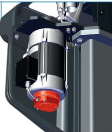
Dreifache Sicherheit durch Motorbremse. Kein Nachlaufen mehr möglich.
