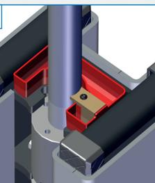
Unkomplizierte Schmierung der Spindel durch Auffüllen des Behälters mit Öl.
