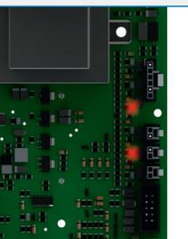
Einfache, optische Fehlerdiagnose durch die auf der Platine angebrachten Leuchtdioden.
