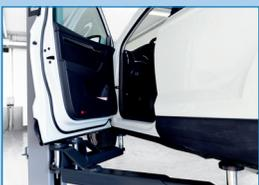
Großer Türöffnungswinkel für leichtes Aussteigen aus dem Fahrzeug durch um 45° gedrehte Säulen (MA STAR 3.5 A).
