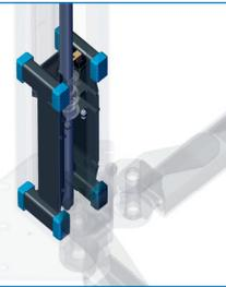
Optimale Lastverteilung durch im H-Profil schienengeführte, nahezu verschleißfreie Gleitsteine (8 Stück / Säule mit bis zu 24 Anlageflächen).
