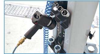
Schlagschrauberhalterung mit integrierter Ablage für Aufnahmeerhöhungen.
