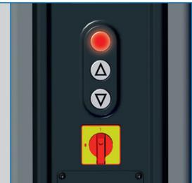
Sensorstörung. Signalleuchte blinkt rot.
