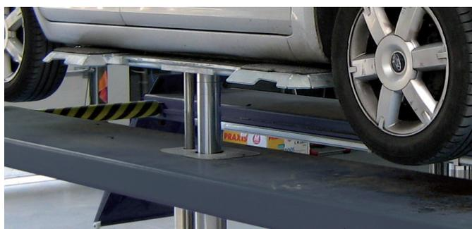
Fahrflächen-Hebebühnen mit Flachträger-Radfreiheber, Schwelleraufnahme Traglast 3,5 t
