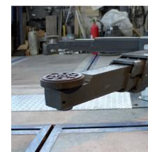
Unterschwenkhöhe am Aufnahmeteller von 101 mm
