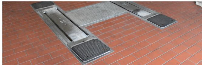
Für leichtes Überfahren der Flachträgeraufnahme. Mithilfe des Einbaurahmens D-ER (VZ 972420) sowie den geraden Auszügen (VZ 972519) kann die Flachträger-Hebebühne bodeneben eingebaut werden. Dadurch ist ein schnelles Heben und Senken ohne Verstellen der Auszüge gewährleistet.
