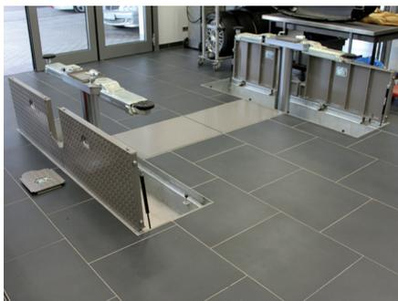
Rahmensystem mit Abdeckplatten, komplett feuerverzinkt
