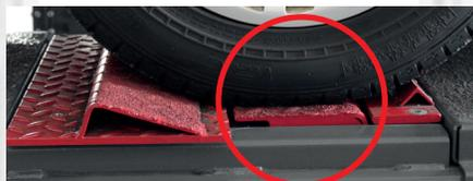
Hintere Prismenhälfte wird automatisch abgesenkt, alle vier Radaufstandspunkte sind höhengleich
