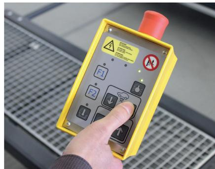
Steuerung mit Kabelfernbedienung
