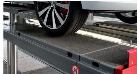
Fahrflächen mit Ausgleichplatten zum Niveaugleich an den Radfreiheber oder an die Achsvermessung.
