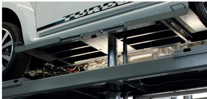
Fahrflächen-Hebebühnen mit Plattform-Radfreiheber, Schwelleraufnahme Traglast 3,5 t
