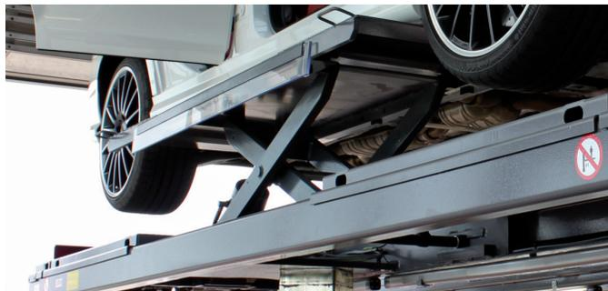
Fahrflächen-Hebebühnen mit Scheren-Radfreiheber, Schwelleraufnahme Traglast 3,5 t
