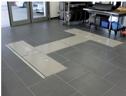
Vollständig abgedeckte Schwenkarmaufnahme mit Radlast 2 t überfahrbar
