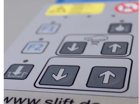
Folientastatur mit leichtgängigen Mikroschaltern
