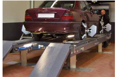
Hohe Genauigkeit als Achsmesshebebühne
