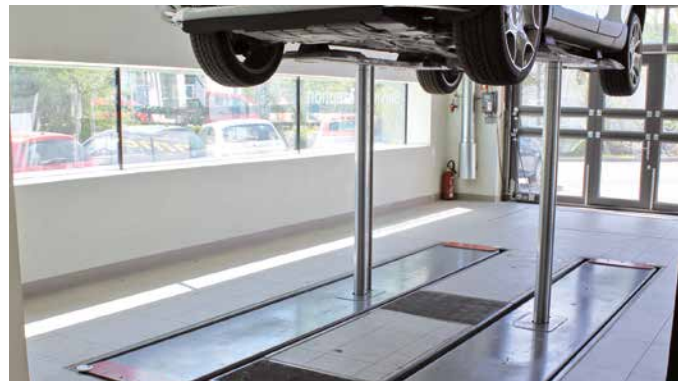
Fahrzeug am Schweller gehoben
