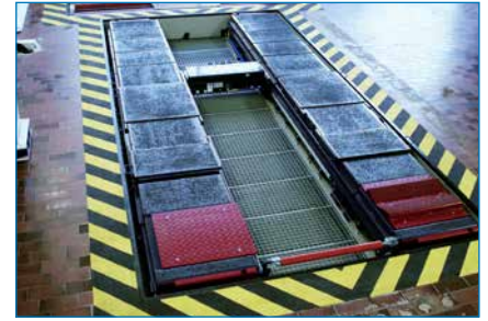
R-AS im Rechteckfundament mit (optionaler) Gitterberostung (Ausstattung für Fahrzeugprüfung).
