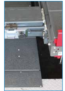
R-AS im Rechteckfundament mit (optionaler) Gitterberostung (Ausstattung für Fahrzeugprüfung).
