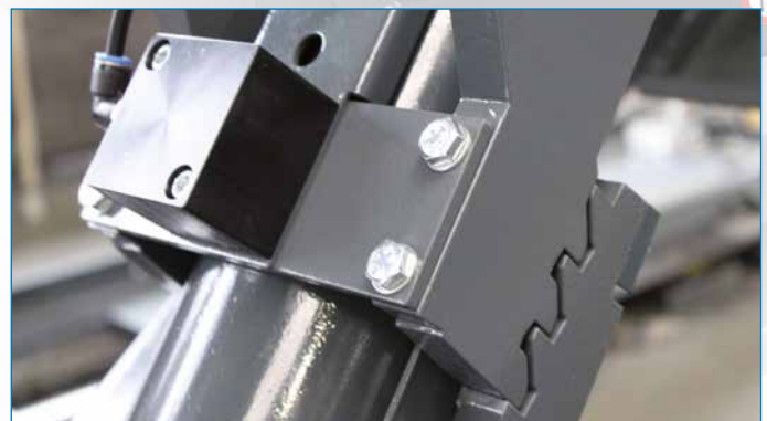
Die Rastenverzahnung wird bei Hebebühnen für die Fahrwerksvermessung (Option „Absetzvorrichtung“) durch Fräsen gefertigt und sichert dadurch eine hohe Präzision auf unterschiedliche Arbeitshöhen.
