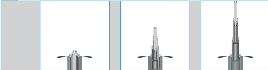
Teleskope fahren stufenlos und mit durchgehend gleich hoher Geschwindigkeit über den gesamten Hub- und Senkweg. Eilsteuerung zum Lastpunkt hin und zurück wird bei Gleichlaufzylindern in allen Teleskopstufen eingesetzt. Diese Eigenschaften gewähren somit eine absolut sichere, solide und ruckfreie Anwendung.
