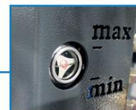
Optimale Eigenkontrolle des Ölstandes durch ideal platziertes Ölschauglas
