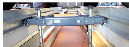
Lange Aufnahmeröhre (400, 600, 800 mm) können von unten durchgeschoben werden und ermöglichen somit einen sehr hohen Aufnahmebereich innerhalb der Grube.
