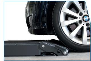
Bei einer Überfahrhöhe von lediglich 105 mm dienen die klappbaren Auszüge zudem als Auffahrrampe.
