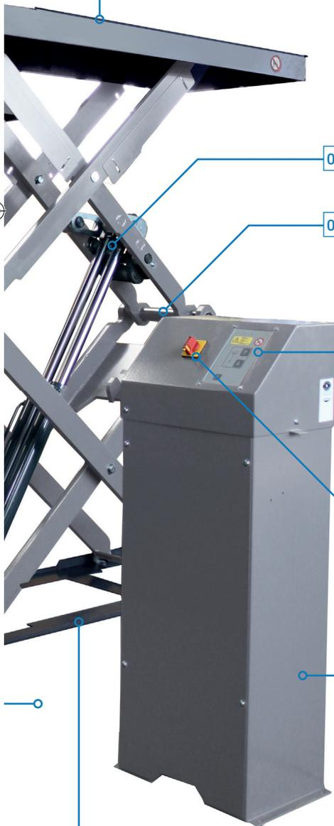
Not-Ab-Funktion bei Stromausfall außerhalb des Gefahrenbereichs am Bedienpult.
