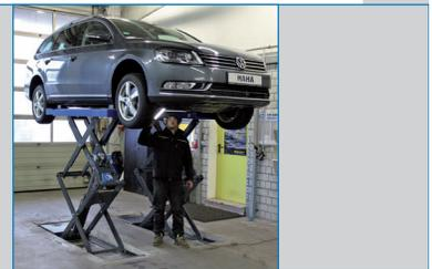
Sehr große Auszugslänge der Aufnahmeplatten (1550 – 2100 mm), dadurch ist das Anheben auch von kleineren Transportern möglich.
