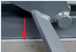
Die im Lieferumfang enthaltenen feuerverzinkten Unterlegbleche verhindern den direkten Kontakt der Bodenrahmen mit Schmutzwasser, wodurch ein zusätzlicher Korrosionsschutz entsteht.
