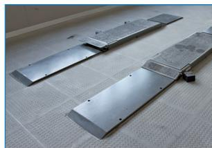
Überfahrrampen um die Überfahrhöhe der bodenauflegend montierten Hebebühne um 40 mm (R-DSF IV 3.5 A) zu verringern.
