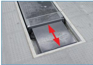
Durch Fundament-Ausgleichskästen (im Lieferumfang) sind die beiden Auszüge auch im abgelassenen Zustand der Hebebühne längenverstellbar. Die Hebebühne kann beim Senkvorgang komplett abgelassen werden, ohne vorher die Auszüge einschieben zu müssen (R-DSF IV 3.5 U).
