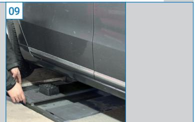
Hoher Korrosionsschutz am Bodenrahmen durch serienmäßige Zweischicht-Pulverlackierung.
