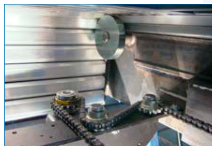
Sichere Kettenführung zur genauen Positionierung der Hubeinheiten
