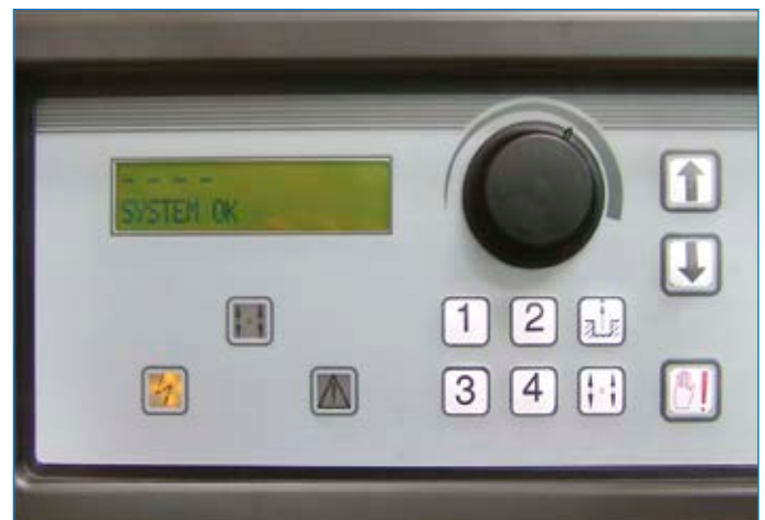
Serienmäßig mit elektronischer Gleichlaufsteuerung der kompletten Hebeanlage mit Abnahme nach DIN EN 1493.
